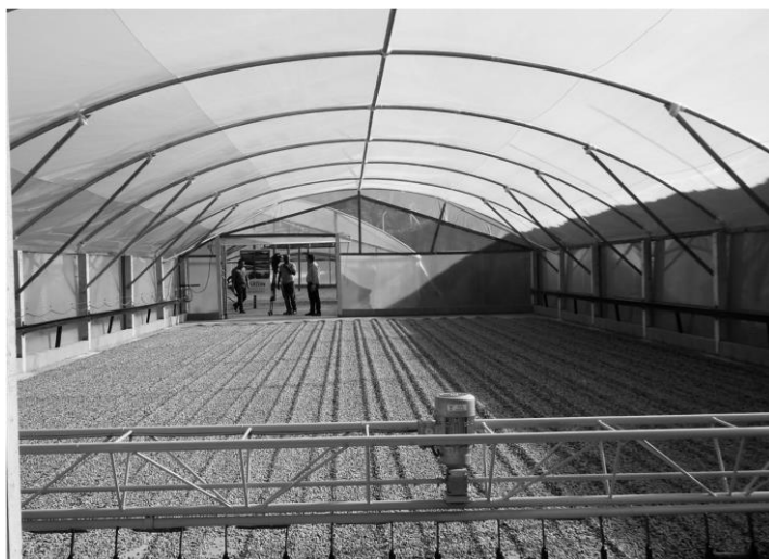
Imagem 1. Foto de um "Revolvedor Automático de Café" projetado em parceria com a Metalúrgica Fardim, com o apoio do Incaper e Prefeitura de Brejetuba-ES.
