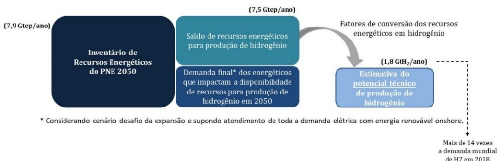
Figura 12 - 10: Esquemático do cálculo de estimativa do potencial técnico de produção de hidrogênio no Brasil
